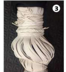
Ejemplo de hilos secundarios fuera de su posición
