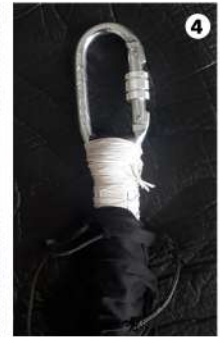
Ejemplo de la protección de los extremos
