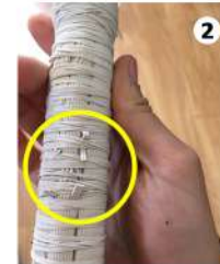
Ejemplo de hilos centrales dañados
